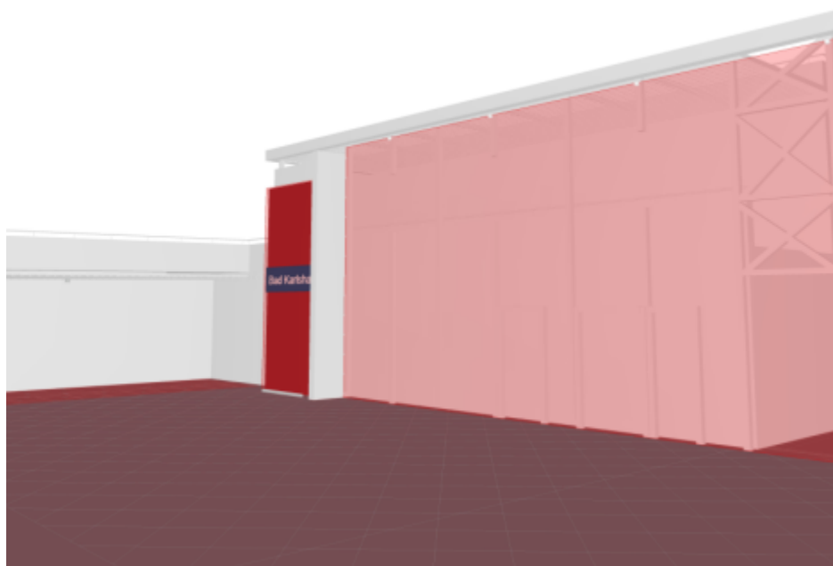
Εικόνα Β.2.4.δ Ενδεικτική τοποθέτηση των φ/σ επί του μεταλλικού σκελετού με περισιωτή επένδυση
